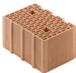
Le **tamponature** saranno realizzate con blocco in laterizio rettificato da 35 cm di spessore, ideale per realizzare edifici a basso consumo. Grazie al sistema di rettifica, che consente di realizzare giunti di malta di appena 1 mm di spessore, permette di eliminare il ponte termico tra un corso e l'altro garantendo un eccezionale isolamento termico. Questo blocco consente di ottenere una conducibilità termica di 0,10 W/mK e una trasmittanza termica di 0,27 W/m<sup>2</sup>K.
